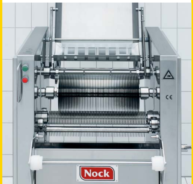
Cortex CB 495/5K SLICER nach Herausnahme der Transportbänder
